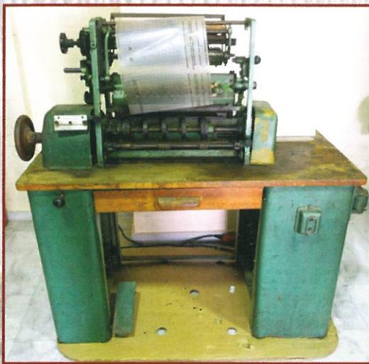
**Καρτελομηχανή. Μηχανή διάτρησης διαφάνειας για τον προγραμματισμό κατασκευής πολύχρωμων σχεδίων στο ύφασμα.**
